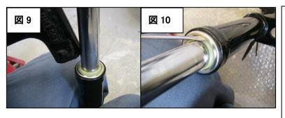
**図 9・・・**最後にダストシールをプラハンなどでフォークアウター部分に叩き込みます。インナーチューブに傷をつけないように注意して下さい。
